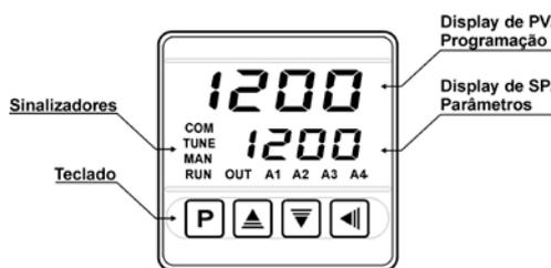
**Figura 7** - Identificação das partes do painel frontal
